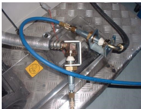
Рис. 4 – При незаполненной системе отключите трубки от компрессора. Fig.5 – Подключите к трубкам шланги при помощи конических адаптеров из набора.
