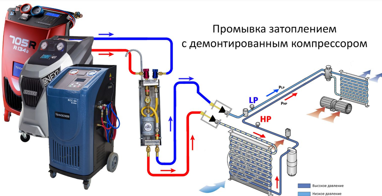
Рис.6 – Заполнение системы кондиционирования. Загрязняющие частицы будут улавливаться фильтром внутри основного блока промывочного комплекта.
