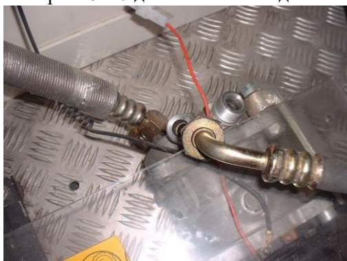
Рис. 4 – При незаполненной системе отключите трубки от компрессора. Fig.5 – Подключите к трубкам шланги при помощи конических адаптеров из набора.
