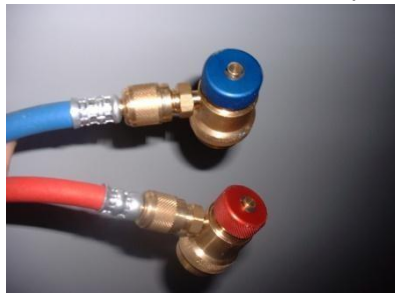
Рис. 9а– Быстроразъемные соединения низкого давления
