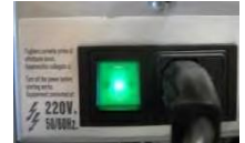
Рис 4 – Разъем питания и выключатель
