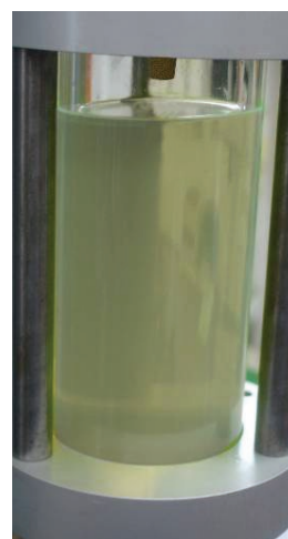
Загрязненный хладагент, неисправный компрессор.
